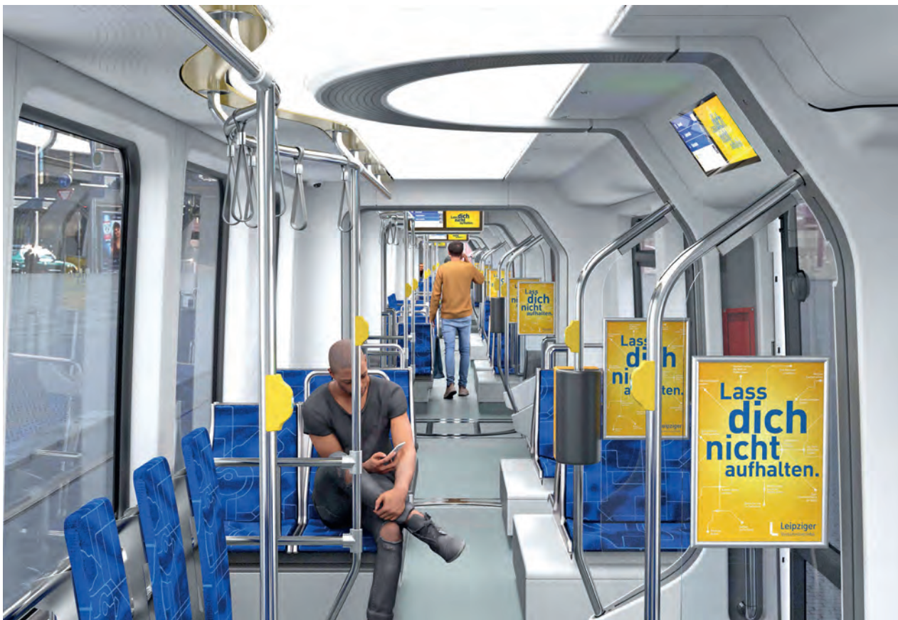
Das Interior der neuen XXL Plus Straßenbahnen für Leipzig: mehr Platz durch breitere Fahrzeuge, breitere Sitze und Durchgänge und größere Rollstuhl- und Kinderwagenbereiche. Bild: Hörmann/Leipziger Gruppe
