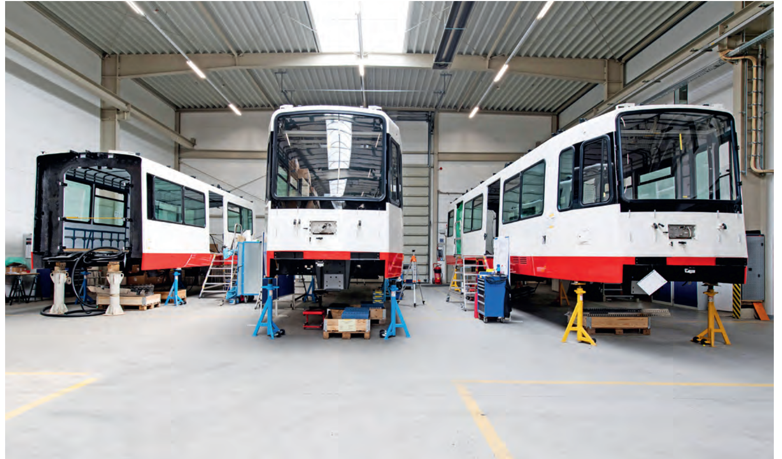
Prototyp für die Modernisierung von insgesamt 64 Bahnen ist das Fahrzeug 348. Er wurde beispielhaft auseinandergenommen und in seiner Konstruktion analysiert, um den Ablauf des Modernisierungsprozesses zu planen. Bild: Anika Dollmeyer/HeiterBlick
