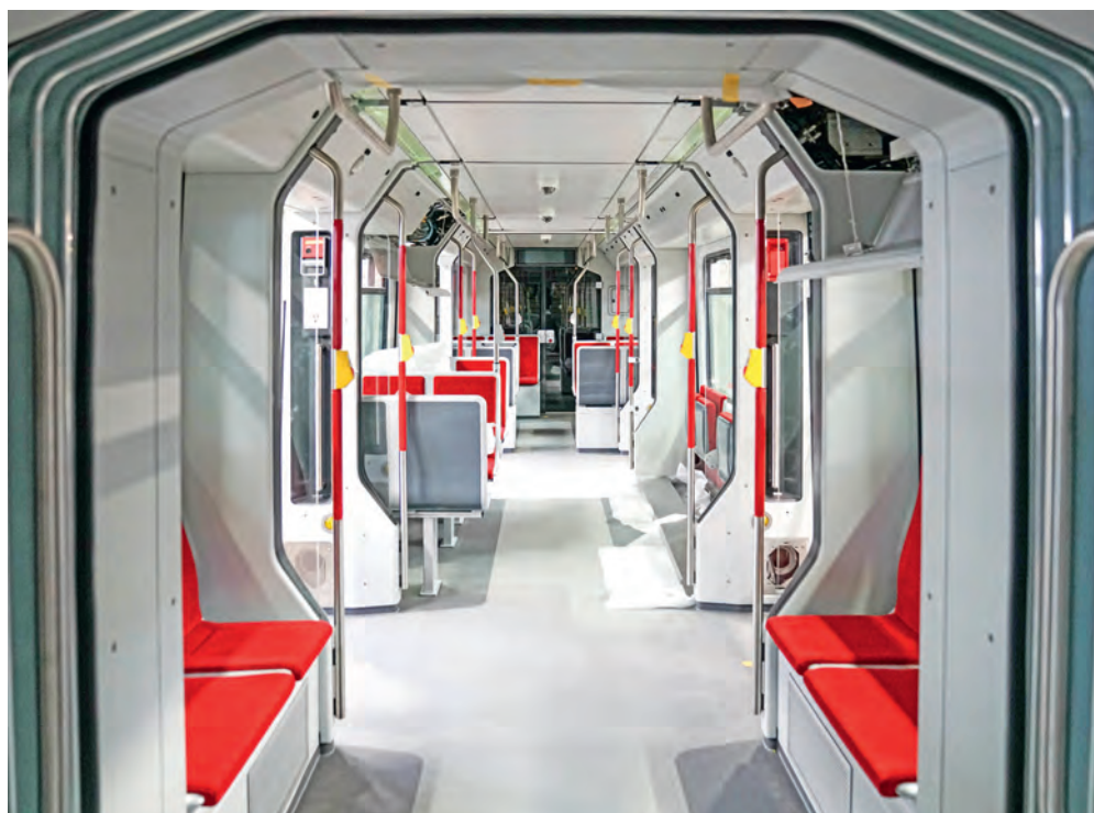
Neben den rotfarbenen, spürbar gepolsterten, rutschfesten Sitzen überzeugt vor allem das Raumgefühl mit jetzt größeren, von allen Türen aus sofort erreichbaren Sondernutzungsflächen für die mobilitätseingeschränkte Fahrgäste oder auch Fahrräder. Weitere Maßnahmen der Barrierefreiheit sind z. B. optimierte Taster und kontrastreiche Griffstangen. Auch Türampeln innen und außen mit auffälliger LED-Beleuchtung fördern die Fahrgastsicherheit, währenddessen Ambiente-Beleuchtung und Infotainmentsystem zum Fahrkomfort beitragen. Bild: Ingo Woelk
