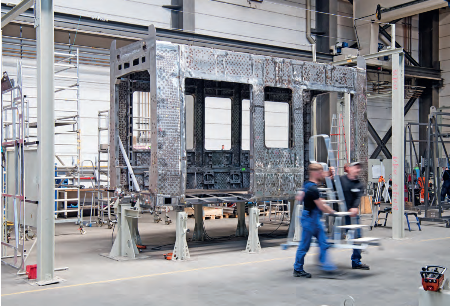
Der Richtstand mit dem ersten gerichteten Wagenkasten des Würzburger Wagenrohbaus. Die unzähligen Wärmepunkte des Flammrichtens zeugen von diesem Vorgang. Bild: Anika Dollmeyer/HeiterBlick
