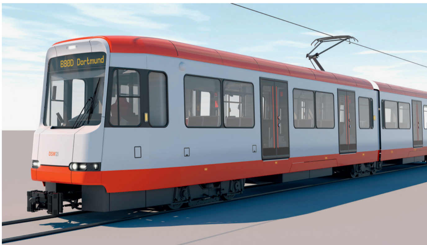
Die Dortmunder Stadtwerke AG DSW21 erneuern ihren Fahrzeugbestand mit der Beauftragung von HeiterBlick über den wagenbaulichen Teil von Neufahrzeugen sowie der Modernisierung von vorhandenen Hochflurstadtbahnwagen. Es handelt sich hierbei um normalspurige Stadtbahnwagen für den Zweirichtungsbetrieb.
