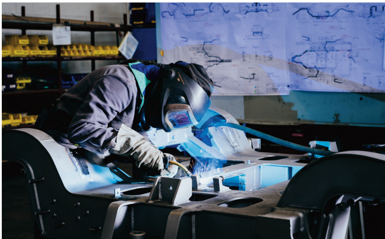
Schweißarbeiten an einem neuen Drehgestell
